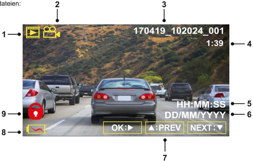
1. Modus: Anzeige, dass sich die Dash Cam im Wiedergabemodus befindet.
