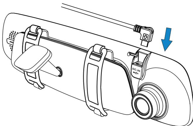
Die Dash Cam schaltet sich automatisch ein und startet die Aufnahme, sobald die Stromversorgung anliegt.
