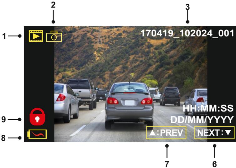
1. Modus: Anzeige, dass sich die Dash Cam im Wiedergabemodus befindet.
