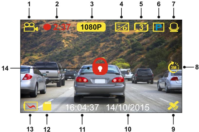
1. Modus: Anzeige, dass sich die Dash Cam im Videomodus befindet.
