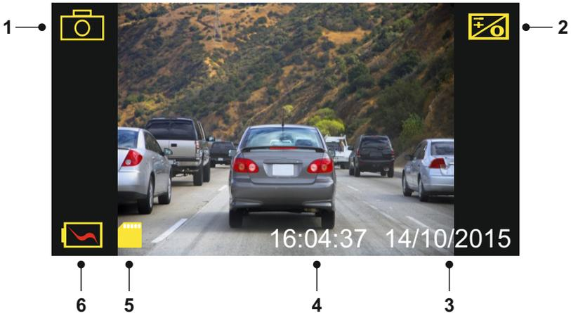
1. Modus: Anzeige, dass sich die Dash Cam im Fotomodus befindet.
